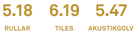
Figur 3. Klimatavtryck för våra golv i kg CO 2 per kvadratmeter. Not: Avser råvara till utleverans enligt A1-A3 i en EPD.
